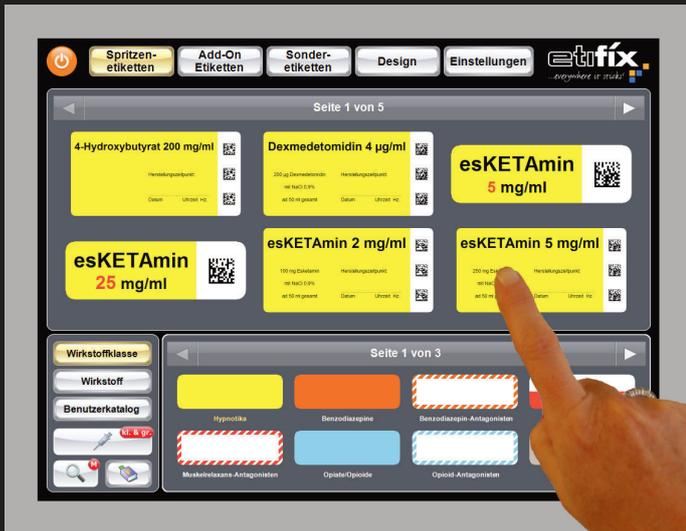
Möglichkeit zur Definition eigener Spritzen- & Zusatzmedikationsetiketten in Bezug auf Konzentration, Wirkstoffmenge, Lösungsmittel oder Füllmenge
